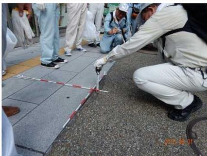
歩道破損箇所の損傷測定作業
